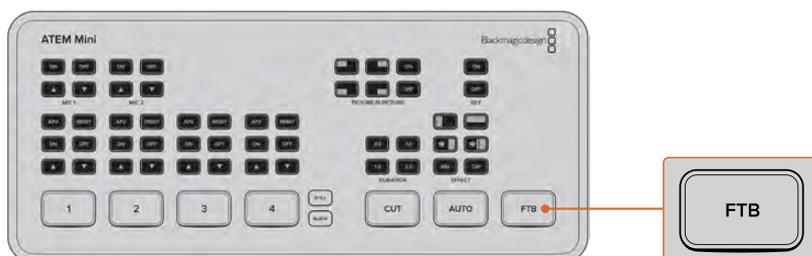
Чтобы выйти из затемнения, нажмите кнопку FTB еще раз. Полное затемнение является эффективным приемом, который можно использовать в самом начале и конце трансляции.
