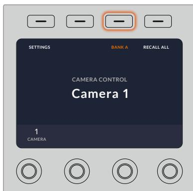
Кнопка «Комбинация» позволяет переключаться между конфигурациями А и В. Для включения или отключения этого режима удерживайте кнопку нажатой в течение нескольких секунд.
