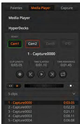
В секции HyperDeck можно выбрать до четырех рекордеров. Для работы с нужным устройством нажмите соответствующую кнопку.
