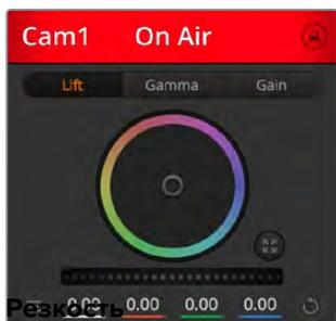
В каждом окне управления отображается строка состояния, поэтому режиссер всегда знает, какое изображение передается в эфир. Цветовые круги позволяют по отдельности менять параметры тени, полутона и света для каждого канала, используемого в YRGB-обработке.
