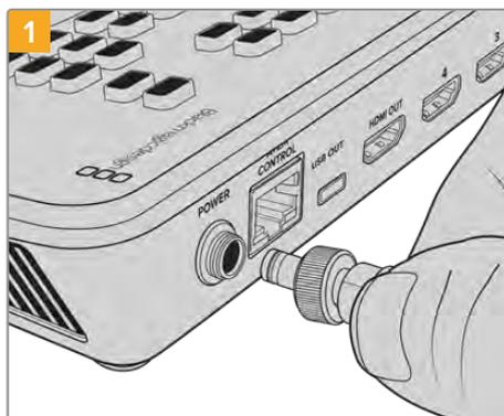
Подключите микшер ATEM Mini к электрической сети через силовой вход с помощью прилагаемого кабеля
