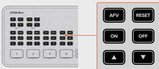
Для каждого входа предусмотрена кнопка AFV, с помощью которой можно включать режим «Звук/видео».
