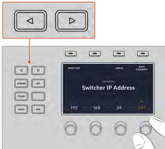
На ATEM 1 M/E Advanced Panel нажмите кнопку «СЕТЬ» и откройте сетевые параметры. Затем с помощью стрелок перейдите к настройке IP-адреса видеомикшера. Используйте ручки, чтобы задать IP-адрес устройства, после чего сохраните внесенные изменения.
