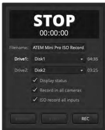
Чтобы включить запись отдельных потоков, поставьте флажок в поле «Разд. запись со входов» в секции «Запись потока».
