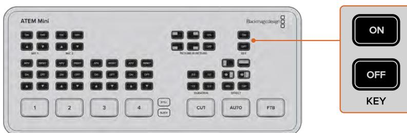
Чтобы включить или отключить модуль первичного кеинга, нажмите кнопку ON или OFF соответственно в секции KEY
