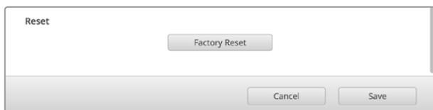
При нажатии кнопки Factory Reset выполняется возврат к настройке DHCP, поэтому конвертер ATEM Streaming Bridge можно автоматически обнаружить в сети
