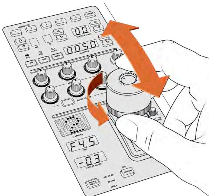
Перемещение джойстика позволяет регулировать чувствительность, а поворот кольца на нем — настраивать уровень черного. Точность настройки обеспечивают соответствующие индикаторы.
