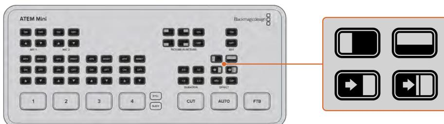
Для выбора вида перехода нажмите соответствующую кнопку (вытеснение с горизонтальной или вертикальной шторкой, выталкивание, сжатие, смешивание или погружение)
