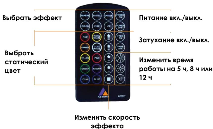
При помощи ARC1 очень удобно включать или выключать несколько световых приборов одновременно. ARC1 также может получать команды конфигурирования, переданные с AsteraApp™ на световой прибор нажатием на кнопку включения питания.
