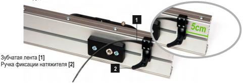
РУстановив натяжитель на требуемом расстоянии, зафиксируйте его ручкой фиксации. После этого приступает к установке зубчатой ленты в электродвигателе. Зубчатая лента устанавливается на двигатель до того, как он крепится к каретке слайдера. Это дает свободу в установке ленты. Фотографии представленные ниже показывают, как правильно установить зубчатую ленту. Установке ленты следую уделить особое внимание.
