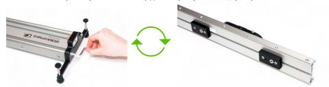
В профиль направляющей вставляем натяжитель с установленной зубчатой лентой. Натяжитель необходимо зафиксировать примерно на расстоянии 5 см от конца направляющей. Если Вы установите зубчатую ленту ближе, то есть вероятность того, что привод ударится о боковую ножку, что может привести к поломке оборудования.
